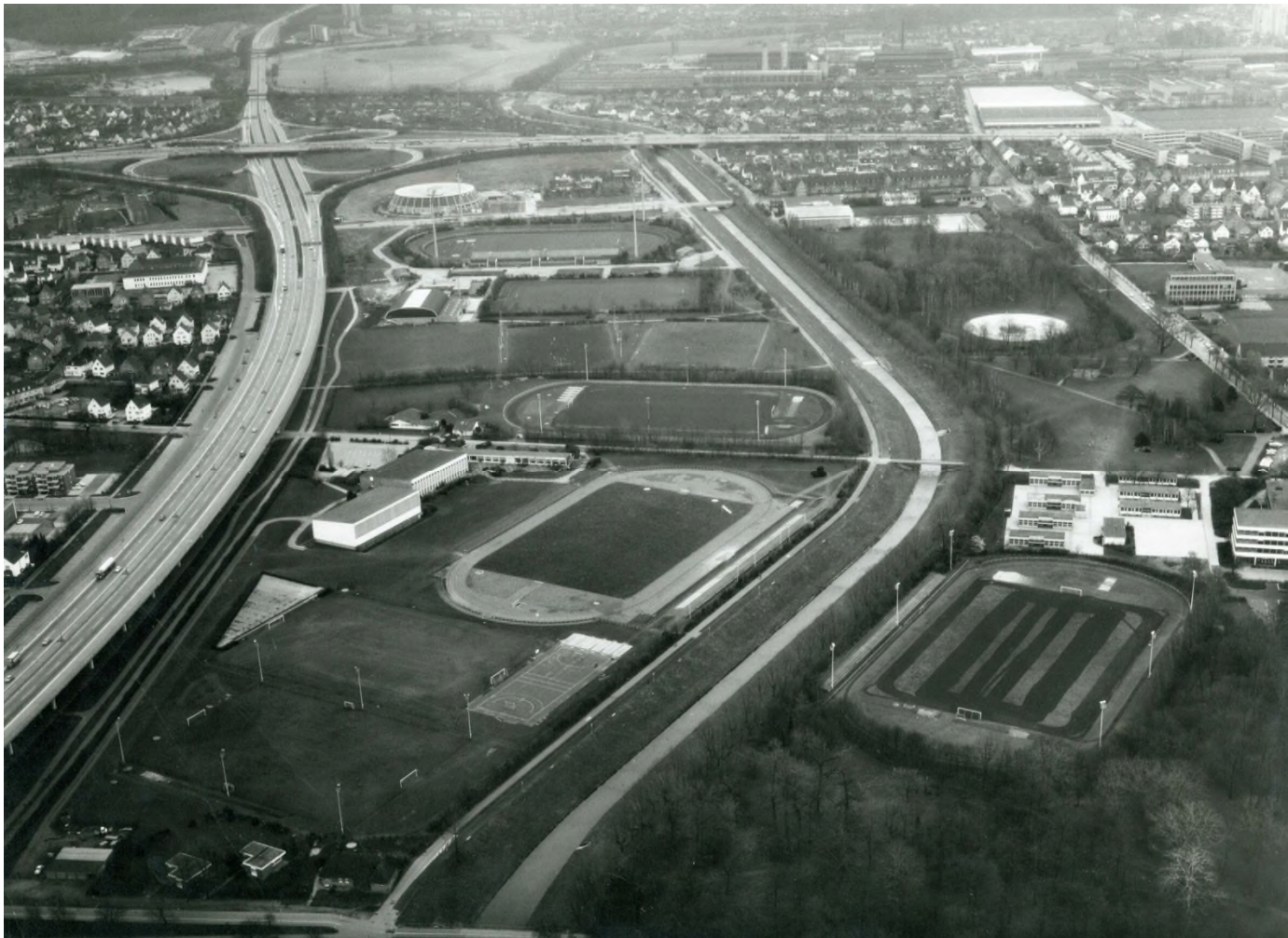
Abb. 51 Zwischen Sport- und Stadtpark verläuft 1975 eintönig und ohne Gehölzbewuchs an ihren Ufern eine kanalartige Dhünn. Etwa in der Mitte des dargestellten Dhünnabschnitts ist eine Sohlschwelle zu erkennen. Etwas darunter mündet von links der von Köln kommende verrohrte Mutzbach. Im Bild links verläuft die Stelzenautobahn (A 1), die aktuell verbreitert werden soll. Ob die Verbreiterung oberirdisch durchgeführt wird oder ob eine Tunnellösung zum Tragen kommt, ist noch offen. Dass einmal die BayArena das Ulrich-Haberlandstadion ablösen wird, lässt sich noch nicht erahnen.
